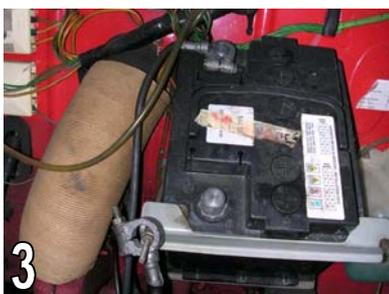
←③ Débranchez la batterie. Cette précaution évite tout court circuit lorsque vous intervenez sur le câblage électrique au niveau du moteur ou ailleurs. Vous aurez besoin d'une clé de 10 ou de 13 selon les modèles.
