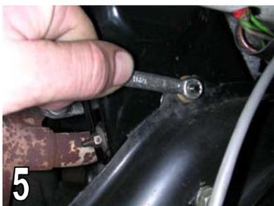
←⑤ A l'aide d'une clé de 8, dévissez en partie les trois écrous de fixation du cache poulie (un devant, un de chaque côté) et enlevez le. Vous pouvez alors voir la courroie qui entraîne l'alternateur lorsque le moteur est en marche.
