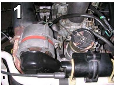
←①②→ Vous êtes face au moteur, l'alternateur ressemble à un cylindre métallique situé à votre gauche, juste à côté et à hauteur de la goulotte de remplissage de carter d'huile. Deux fils y sont branchés : l'excitation et le plus, le moins se faisant par la masse.
