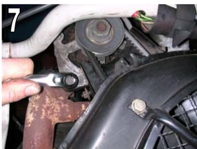
←⑦ Le boulon de fixation de l'alternateur à la tubulure d'échappement se démonte avec du 14. C'est lui qui vous permet de régler la tension de votre courroie. Désengagez la courroie avant d'ôter tout à fait le boulon.
