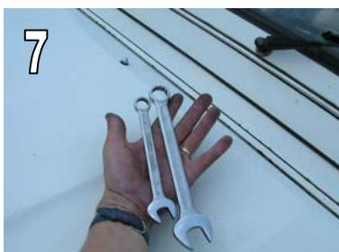
← ❼ Deux clés mixtes seulement sont nécessaires au remplacement des amortisseurs. Une clé de 14 pour les flasques avant et une clé de 19 pour les axes d'amortisseurs. Certains modèles sont équipés d'écrous en 17, 18, ou 21. Vérifiez les vôtres.
