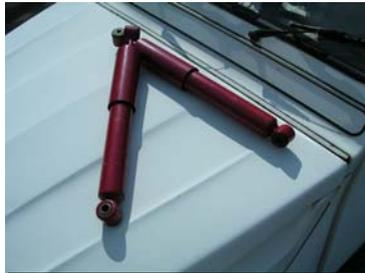
Montée en éléments séparés, la suspension de la deuche n'a pas besoin d'être changée en intégralité comme sur la plupart des automobiles. Seules les parties affaiblies seront remplacées, simplement en quelques tours de clés.
