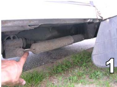
← ❶ Les modèles de 2 CV étant nombreux, vérifiez d'abord que vous avez les bons outils pour démonter les écrous d'axes d'amortisseurs. Un amortisseur pour chaque roue, les écrous ne sont pas toujours les mêmes à l'avant et à l'arrière. La plupart du temps, une clé de 19 sera adaptée.
