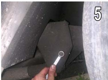
← ❺ A l'aide d'une clé mixte de 14, démonter la flasque avant. Un des trois écrous est moins accessible que les autres, le démontage de l'aile avant n'est toutefois pas indispensable. Une fois la flasque tombée, dévisser l'écrou avec une clé mixte.
