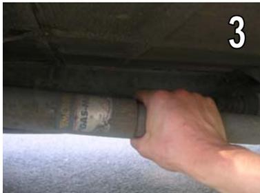
← ❸ Une fois les écrous tombés, tirer sur l'amortisseur pour le dégager de ses deux axes en même temps pour ne rien abîmer des filetages. L'axe doit être nu pour remonter le nouvel amortisseur avec un peu de graisse. S'il reste une bague cylindrique, l'ôter en utilisant du dégrissant et une pince.
