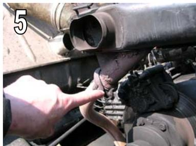
← ❺ Les colliers sont à démonter et remonter avec deux clés de 11. Du dégrissant sera nécessaire et parfois même des vis neuves puisque les vieilles viennent parfois à céder. Au remontage, les deux parties d'échappement doivent être bien jointes.
