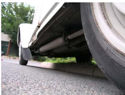
**L'échappement de la 2 CV comporte un long silencieux horizontal placé sous la carrosserie. Derrière lui, un tube. Avant, un col de cygne et une bête à corne. Une petite ménagerie à surveiller pour ne pas réveiller les démons de la route.**
