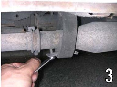
← ❸ Pour remplacer le silencieux, démontez l'autre collier de serrage ainsi que les vis des pattes qui le tiennent. Gardez précieusement la vis et la petite patte en métal au cas où le silencieux neuf n'en comporterait pas.
