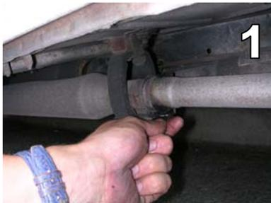
← ❶ Deux modèles de tubes arrière existent : un long sortant derrière la 2 CV et un court sortant juste avant la roue. La sonorité est légèrement différente. Pour le remplacer, dévisser l'écrou de serrage du collier afin de libérer le tube.
