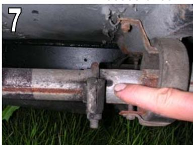
← ❼ Les différentes parties d'échappement se relient entre elles par des diamètres de tailles différentes. Les rainures qui permettent de jouer sur leur ouverture ne doivent pas laisser les gaz s'échapper une fois le remontage effectué.
