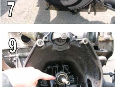
← **7** Une fois le moteur désengagé et tourné sur le côté, dévisser les écrous de fixation du mécanisme d'embrayage avec une clé de 11. Le disque d'embrayage se trouve derrière. Il touche à la fois le mécanisme et le volant moteur.
