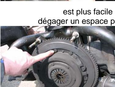
← **5** La même clé servira à dévisser les deux écrous supérieurs de fixation du moteur avec la boîte de vitesses. Sur deux des axes de fixation, se trouvent des centreurs (petits cylindres) qu'il ne faudra pas oublier.
