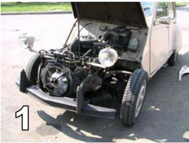
← **1** Démontez les éléments de carrosserie avant facilite de beaucoup les interventions. Si certains trouvent plus simple de démonter complètement l'avant de la 2 CV barre de phares comprise, il est aussi possible de dégager le moteur de la boîte en le laissant sur le châssis.
