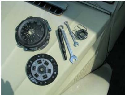
**L'embrayage le plus répandu des dernières deuches produites est un mécanisme à diaphragme. Remplacer le système nécessite de changer les trois parties qui le composent : la butée, le mécanisme et le disque.**
