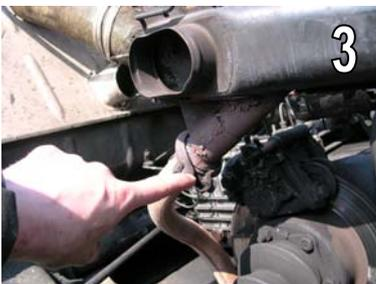
→ **2** Commencez par ôter le filtre à air complet en le dévissant de la boîte de vitesses et du moteur. Une clé de 11 et de 17 (ou 16 selon les modèles) vous seront utiles, ainsi qu'un tournevis pour le coude de caoutchouc du carburateur.
