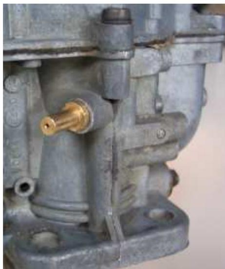
*trou de 4mm, et filetage en M5, dans le carburateur double corps (voir photo) parce que ils sont déjà préparés pour une prise de dépression. Le mamelon est fourni avec le 123 \ EVO.*
