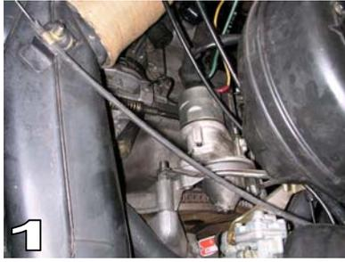
←①②↘ Vous êtes face au moteur. Le démarreur ressemble à un cylindre métallique situé en face de vous, derrière le carburateur et sous le filtre à air. Il est surmonté à gauche d'un autre cylindre plus petit, le solénoïde, où sont branchés deux fils : le pôle plus de la batterie et le fil commandant le lancement, le pôle moins se faisant par la masse.
