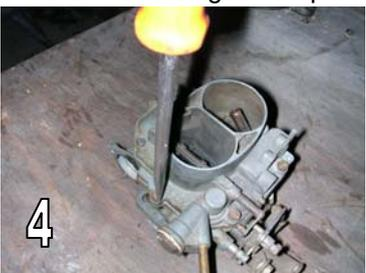
← ❹ A l'aide d'un gros tournevis plat, retirer les 6 vis qui maintiennent le couvercle sur le carburateur. Certains modèles ont des vis plus longues en fonction de leur place. Il convient donc de bien les repérer pour un remontage conforme sans dégradations.
