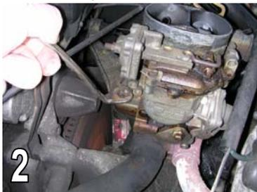
← ❷ Les plus avertis utiliseront une clef plate de 12 dont l'une des extrémités est coudée et meulée sur l'extérieur, pour dévisser les quatre écrous qui retiennent le carburateur à la pipe d'admission. Il n'est pas nécessaire d'opérer ainsi pour un simple nettoyage.
