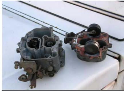
A simple ou à double corps, le carburateur de la Deuche ne comporte pour certains aucunes membranes. Les causes d'usures sont donc minimales. Mais l'encrassement peut être source de dysfonctionnements. A nettoyer !
