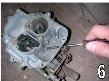
← ❻ Le gicleur d'essence du deuxième corps est facilement accessible au fond de la cuve de gauche. Celui du premier corps demande d'enlever le bouchon-écrou de 12 situé sur le côté arrière droit du carburateur avant d'être dévissé à l'aide d'un petit tournevis plat. S'il ne sort pas, souffler dans la chambre.
