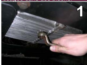
➡➤ Après avoir ouvert la goulotte de remplissage du carter moteur, dévissez l'écrou bouchon de milieu de dessous de carter avec une clé de 21. Le mieux est d'effectuer sa vidange l'huile légèrement chaude pour une meilleure fluidité.
