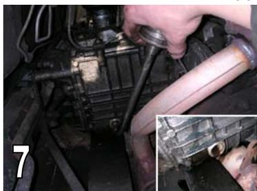
➡➤ Si vous n'avez pas de pompe coudée comme sur la photo, utilisez une grosse seringue pour remplir le carter de boîte par l'écrou bouchon situé sur la droite. Le niveau normal fait couler légèrement l'huile sur le filetage lorsque la 2 CV est sur un sol horizontal.
