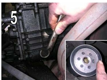
➡➤ Avant de remonter à la main et sans forcer le filtre à huile, recouvrez légèrement le joint d'huile pour une meilleure étanchéité. Terminez le serrage par un petit quart de tour, à la main. Profitez pour démonter l'écrou de remplissage de la boîte de vitesses, situé sur le côté droit du carter de boîte, vers l'arrière.
