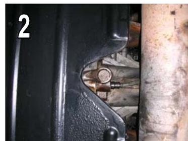
➡➤ Profitez d'être sous la 2 CV pour desserrer également l'écrou bouchon de boîte de vitesses. Il se situe un peu plus en arrière de la 2 CV, avant le pot de détente. Vérifiez que les écrous soient bien propres et exempt de limaille.
