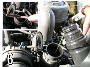
➡➤ Remplir le carter moteur d'environ deux litres et demi d'huile 15W40. Vérifiez le niveau petit à petit avec la jauge, en la nettoyant à chaque fois. Faire tourner le moteur au ralenti pour remplir le filtre à huile. La trace d'huile doit se trouver entre les deux repères de la jauge.
