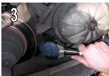
➡➤ Pendant que l'huile s'écoule, démontez le filtre à huile, utilisez au besoin la clé adaptée. Réalisez cette opération rapidement pour éviter de vider le filtre de son huile partout sur le châssis et le sol.
