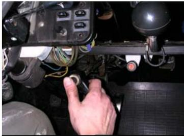
La poignée de frein à main, située sous le levier de vitesse, ressemble à celle d'un parapluie. « Quatre roues sous un parapluie », voilà la poignée qui tient le tout en place !
