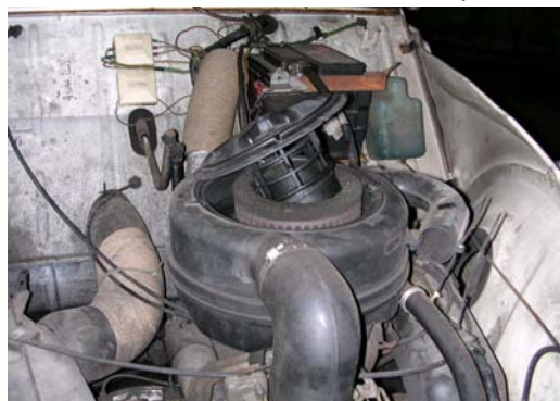
Le filtre à air est situé au dessus du moteur et protège ce dernier des poussières. En plastique, le couvercle est sensible au retour de pression d'un mauvais réglage d'allumage. En métal, il est protégé par un écrou à ailettes.
